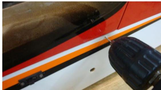
Agujereamos con una mecha de 1.5mm de ambos lados con la cabina bien colocada y atravesando lateral del fuselaje y orejitas de la cabina.
