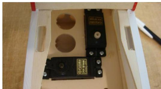
Servo de timón y atornillamos ambos con sus respectivos tornillos.
