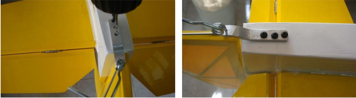
Colocar el tren de cola y agujerear con una mecha de 1.5 mm. Y colocar los tres tronillos Parker.
