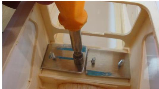
Colocar los tornillos desde la parte inferior, y las tuercas desde el interior del fuselaje.
