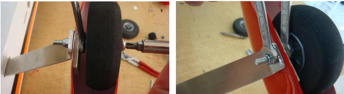
Apretamos con una llave numero 7 y con un destornillador arrimamos el tornillo para que nos quede bien arrimado y teniendo en cuenta que no nos apriete la rueda y nos imposibilite el correcto funcionamiento de la misma si vemos que se no queda la rueda sin movimiento quitarle espesor a los separadores.
