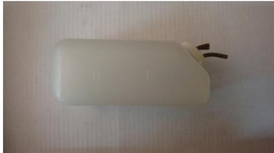
Hacemos una prueba de sellado, tapamos dos de los caños y en el tercero inflamamos el tanque y tapamos el tercer caño, lo dejamos unos segundo corroborando que no tenga fugas.
