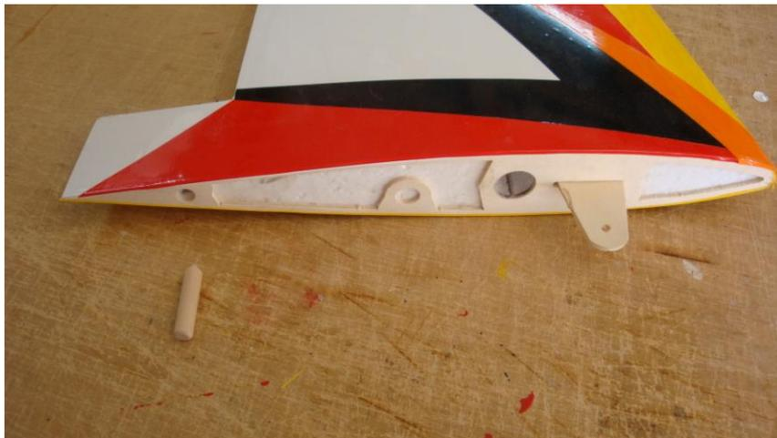
Pegamos los tetones de pino anti rotación. En ambas semialas corroborar que queden bien alineados con respecto al fuselaje.
