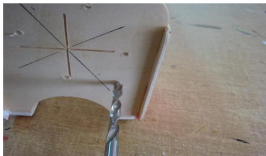
Utilizamos mecha de 6mm. Para las mangueras y uno de 3mm, para el mando de acelerador.
