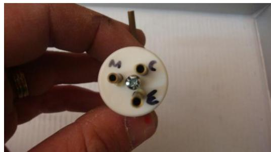
Colocamos en uno de los caños cortos el chupador presentándolo desde la parte de afuera del tanque para corroborar que quede a uno 5-8 mm. De distancia al tope del tanque. Y luego marcamos en la tapa para que utilicemos cada uno de ellos así no nos equivocamos al instalar las mangueras al motor.
