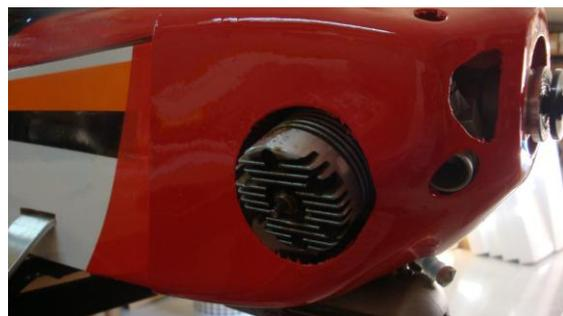
Quitamos la aguja para facilitar la colocación del cowl procedemos a colocarlo y realizar el orificio de la boca del carburador de este ultimo no hacemos plantilla ya que una vez colocado el cowl lo podemos ver desde la entrada de aire del frente del cowl.
