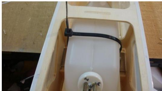
Sujetamos el precinto y tenemos terminada la instalación del tanque.
