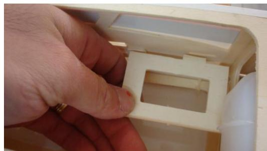
Como vemos en la figura podemos colocar la bandeja de servo de motor en cualquier posición de ambos laterales.
