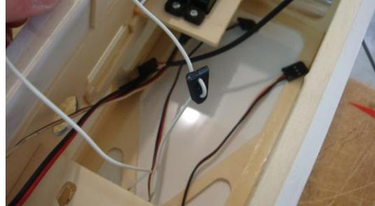
Así nos quedaría el mando terminado. Pasamos la antena del receptor, utilizamos un extremo de leva de servos para trabar la antena a una distancia que nos quede holgada dentro del fuse para que no quedé tirante la salida del receptor.
