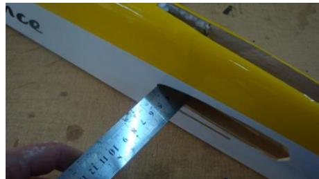
Medimos las distancias del ancho del fuselaje para el borde de ataque y borde de fuga del estabilizador.
