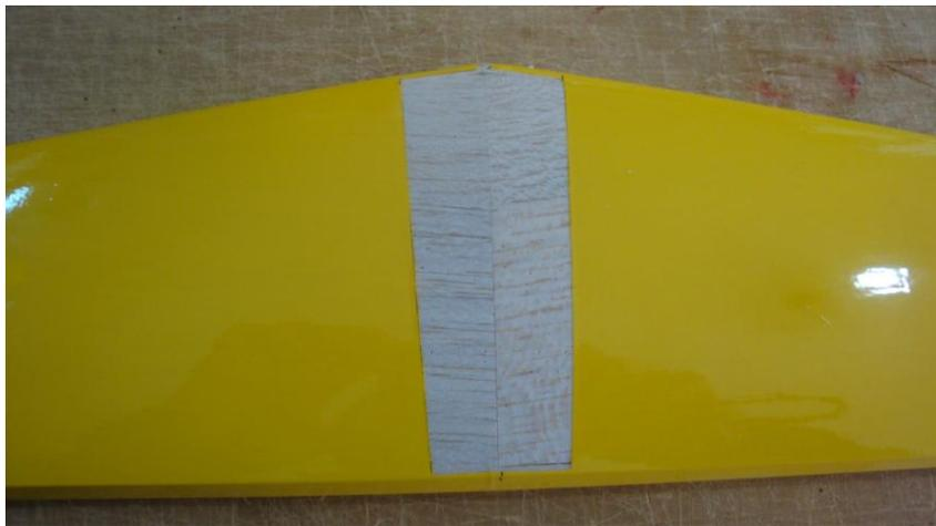
Con una hoja de corte nueva o que este bien afilada cortar el monokote con suavidad para no cortar el enchapado del estabilizador.
