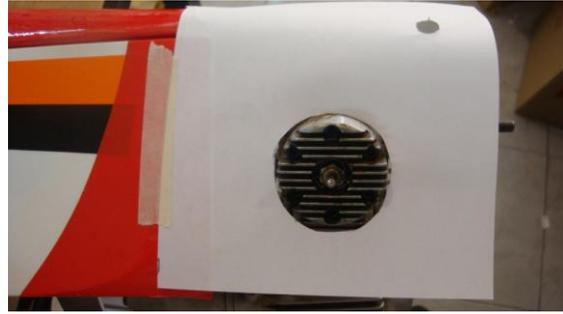
Tomamos el cowl de no tener los calados frontales realizarlos con un mini torno con disco de corte o fresa.
