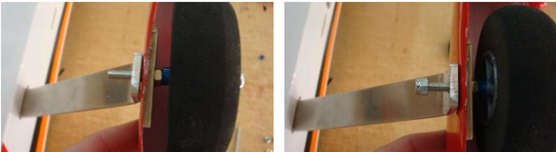
Colocamos la tuerca autofrenante. Y sujetar hasta el tren de aterrizaje.
