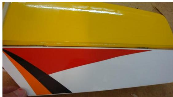
Colocamos epoxi en el elevador y luego que seque en el estabilizador, al instalar el elevador corroborar que quede una luz pareja a lo largo de todo el elevador.
