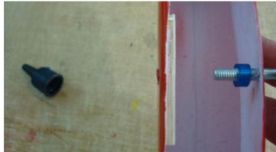
Pegamos la madera de terciado de refuerzo para que nos quede con mayor rigidez dicha zona. Colocamos el tornillo una vez que pasamos para dentro del carenado le colocamos el primer separador.
