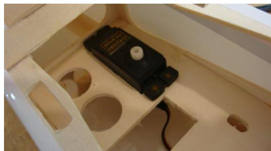
Tal como se puede observar en la foto el servo de elevador a un costado cuando coloquemos el mando quedara en el centro del fuse.
