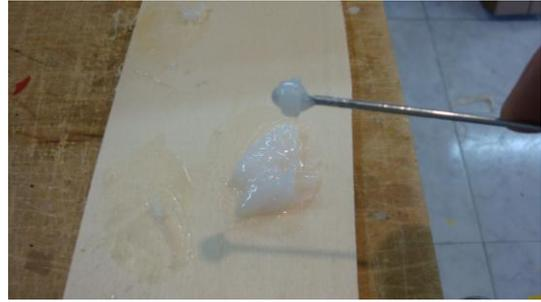
Punteamos el estabilizador con ciano para que no se nos mueva; colocamos cinta de enmascarar en el estabilizador y fuselaje para que quede prolijo el epoxy.
