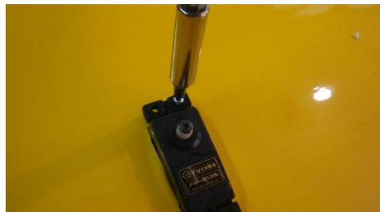
Agujereamos con una mecha de 1.5mm. Y luego colocamos los tornillos para cada servo.
