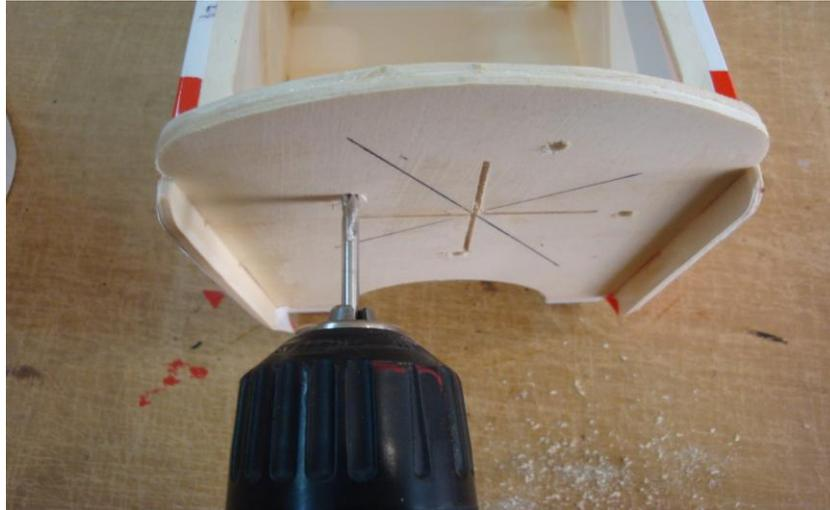
Al ser madera la mecha a utilizar es la misma medida del tornillo a utilizar en este caso 3mm.
