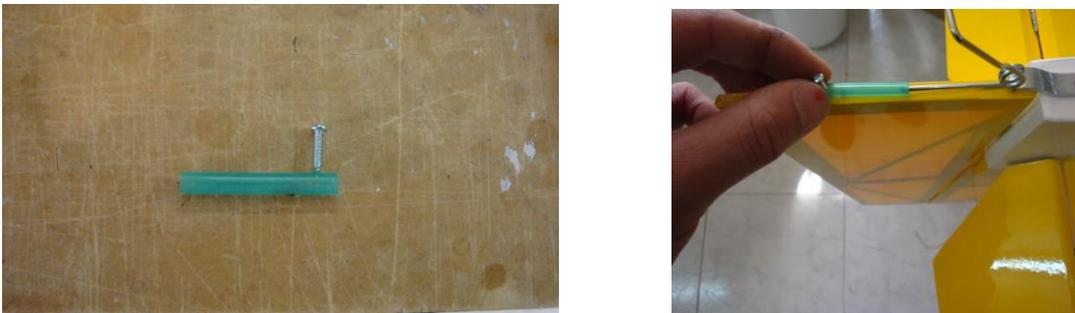
Ponemos la manguera de silicona con un tornillo Parker atornillado al timón, dejando una distancia de 10mm. Entre la punta del alambre y el tornillo para que actúe como salva-servo.
