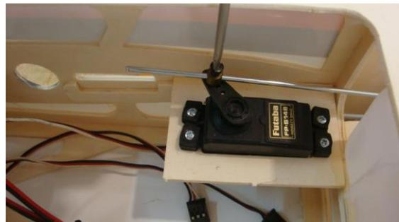
Ponemos un clevis en el extremo de la rosca para conectarlo al carburador y apretamos la leva de sujeción conocida como torre de mando.
