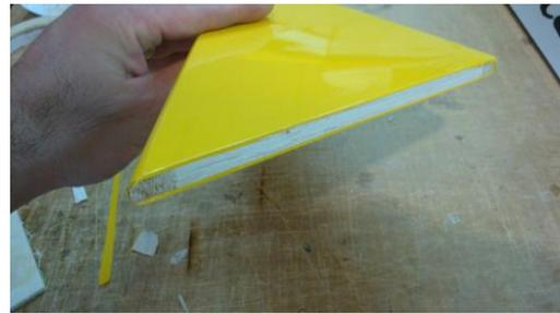
El timón utilizamos la misma técnica del estabilizador, antes colocamos epoxi en el fuse y luego colocamos la deriva.
