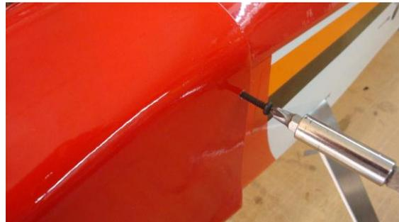
Sujetamos el cowl para que no se nos mueva y comenzamos a realizar los agujeros para atornillarlo en este caso utilizamos una mecha de 1.5mm, ya que utilizaremos tornillos Parker de ser modelos de mayor tamaño es aconsejable utilizar tuercas autoclavantes (blind-nuts) al menos de 3-4 mm.
