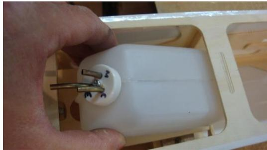
Pasamos un precinto o dos por la bandeja de tanque y colocamos el tanque.
