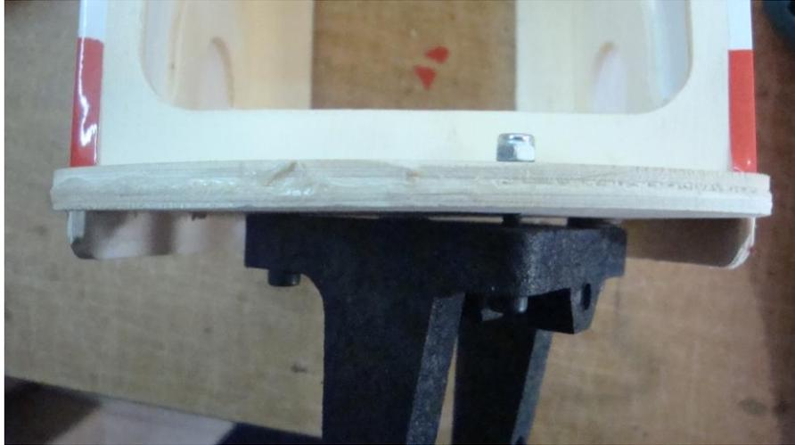
En este caso ya le colocamos una arandelas de separación para darle el anti-torque al motor, es aconsejable unos 2° hacia la derecha y 1-2° hacia abajo dependiendo del motor y hélice a utilizar.
