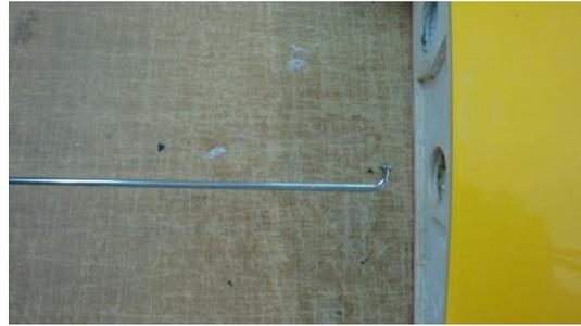
Cortamos el monokote de la cavidad del servo de alerón, pasamos un alambre para poder pasar el cable del servo.
