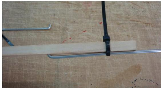
Para realizar los mandos utilizamos las varillas de pino de 6x6 y las varillas que trae el Kit. la presentamos desde la parte inferior del fuse para poder marcar el corte de las varillas y luego doblar uno de sus extremos para que entre y trabaje dentro de la varilla.
