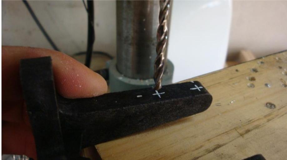
Agujerear con una mecha de la medida del tornillo a colocar en este caso utilizamos una mecha de 3.25mm. Porque los tornillos a utilizar son de 3mm de espesor.
