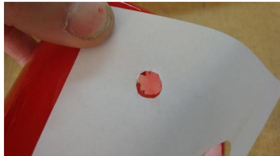
Trasladamos esa misma hoja al cowl respetando algunas marcas de alineación que debemos realizar para alinearlos con el fuselaje, cortamos el cowl con una fresa es lo que aconsejamos que es más fácil de manejar que el disco de corte.
