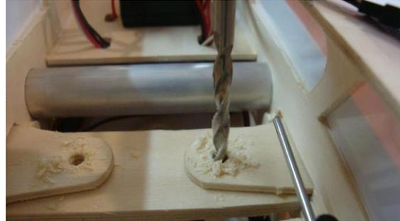
Colocamos las semi alas; agujereamos con una mecha de 4.5mm.
