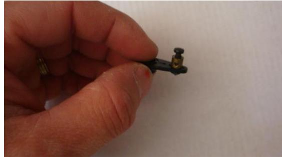
Lo colocamos desde el motor hacia dentro del fuse colocamos un leva de retención en la leva del servo.
