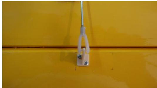
Tomamos una varilla de mando, colocamos un clevis en uno de sus extremos lo colocamos en el cuerno de mando.
