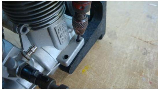
Colocamos el motor en la bancada respetando las medidas desde la F1 hasta el plato de apoyo de la hélice. Marcamos con un puntero.
