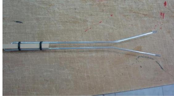
Le colocamos dos precintos a cada alambre a sujetar.
