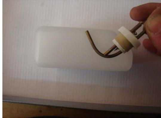
Colocamos los tres caños en el tapón. Y doblamos el mas largo con la curva que se ve en la imagen para el presurizado del tanque, tener cuidado que no se toque con la parte superior del tanque.
