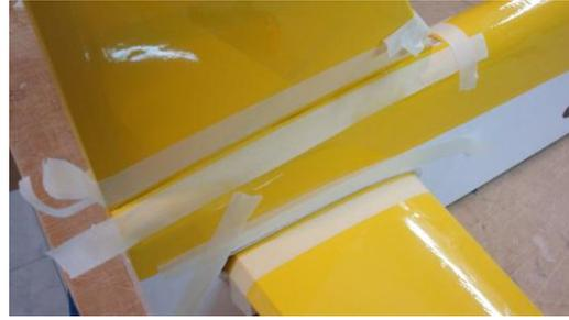
Colocamos cinta de enmascarar en el timón y la parte superior del estabilizador y colocamos epoxi.
