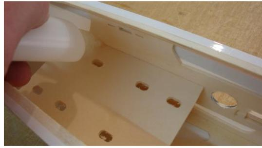
Pegamos la bandeja de servo con ciano al igual que la bandeja de servos y receptor, luego recomiendo reforzar con epoxi.
